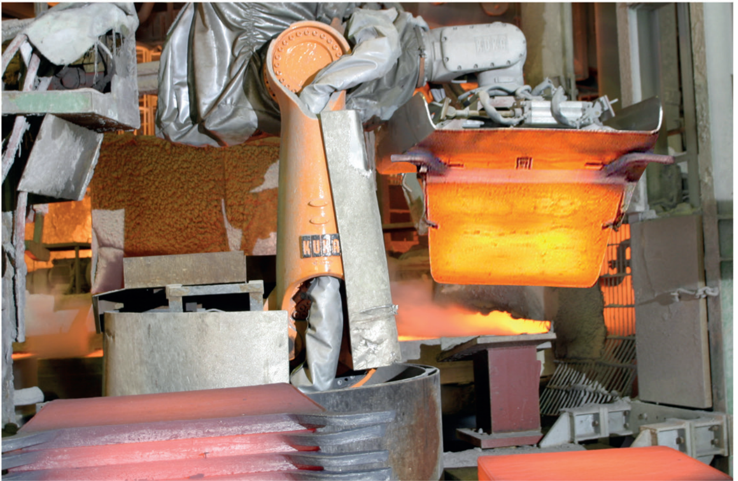
Handling-Roboter für gegossene Kupferanoden: Temperatur bei Aufnahme 800°C
