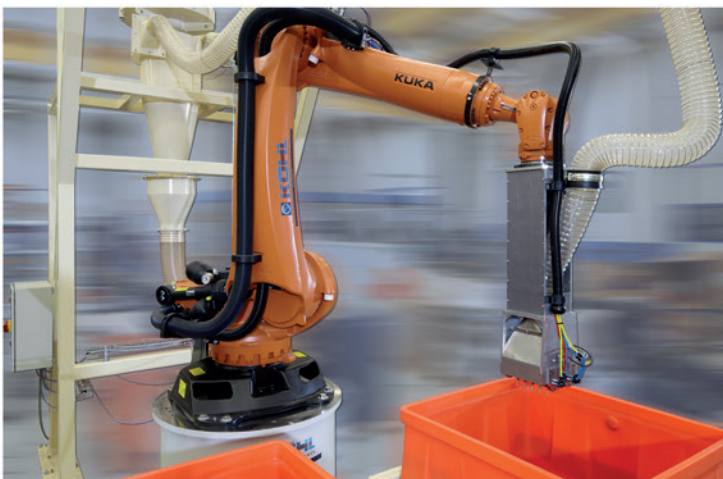
KÖHL Entwicklung: Automatisches Auflockern und Absaugen von Rohtabak
