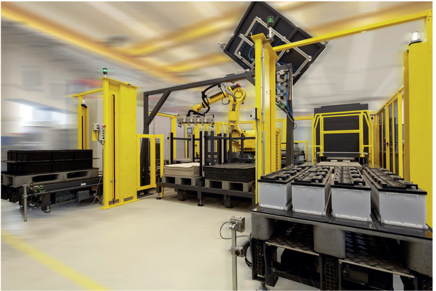
Vollautomatische Roboterzelle zum versandfertigen Palettieren verschiedener Fahrzeug-Batterien
