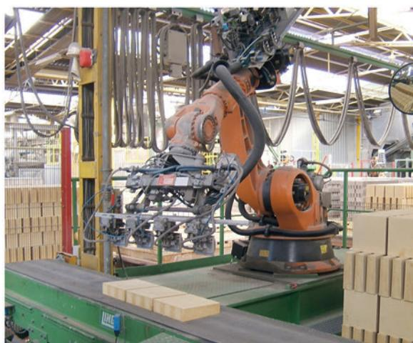
Der KÖHL Fokus bei den Handling- und Automatisierungssystemen für die Feuerfest-Industrie liegt auf komplett automatisierten Anlagen für die Ofenwagenbeladung und für die Entnahme der geformten Produkte aus der Presse. Je nach Anforderung und Kundenwunsch kommen Industrie-Roboter der führenden Hersteller, wie ABB, FANUC und KUKA bzw. bei Bedarf auch Portale, zum Einsatz.
