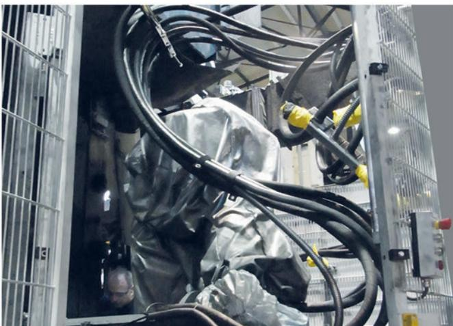
Sprühroboter an Schmiede zum Kühlen und Trennmittel-Sprühen
