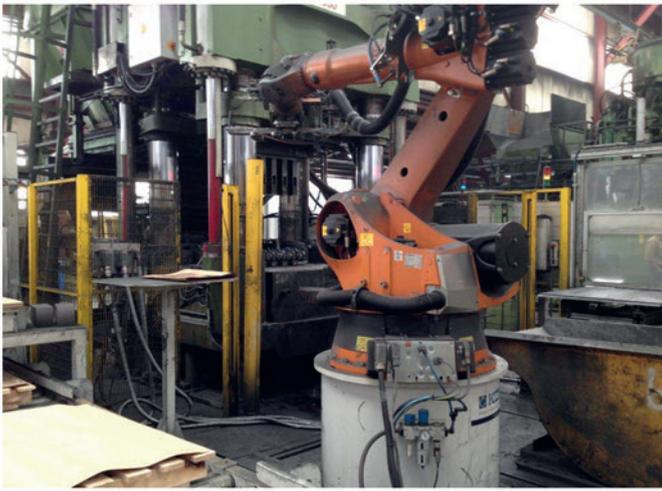
Setzroboter an einer Feuerfest-Steinpresse
